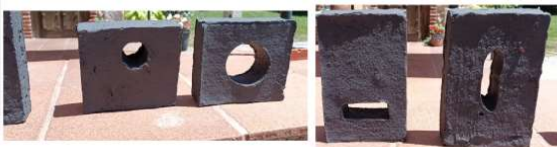
Figura 6. Piezas cerámicas con diferentes diseños y tamaños para aves insectívoras, pequeñas rapaces y murciélagos, destinadas a clausurar mechinales de edificios históricos. Diseño: Carlos Cuéllar Basterrechea/GREFA.
